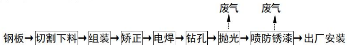
图 3-1 原有工程生产工艺流程及产污环节
