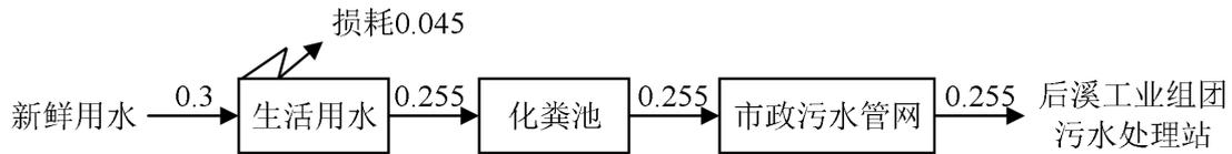
图 2-1 本迁建项目水平衡图 (t/d)
