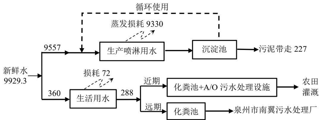
图 2.4-1 项目水平衡图 (单位: t/a)
