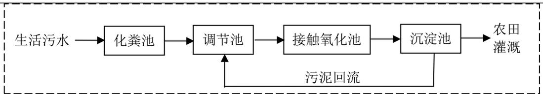
图 4-2 污水处理设施工艺流程图
