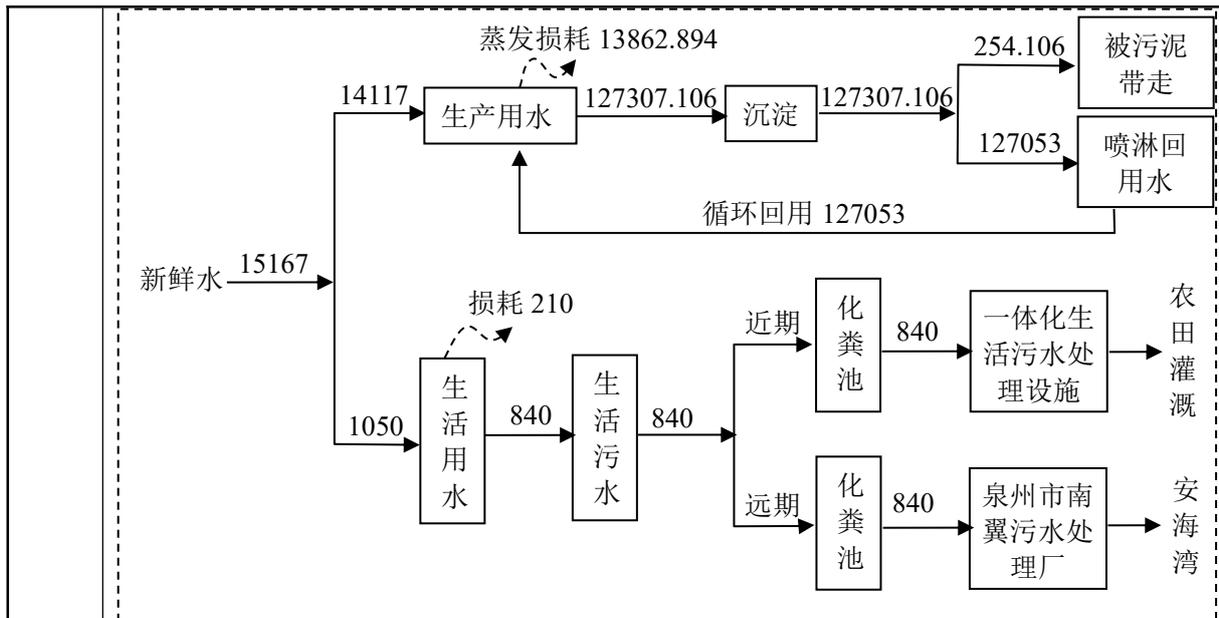
图 2-1 项目给排水平衡图 (单位:  $\text{m}^3/\text{a}$ )
