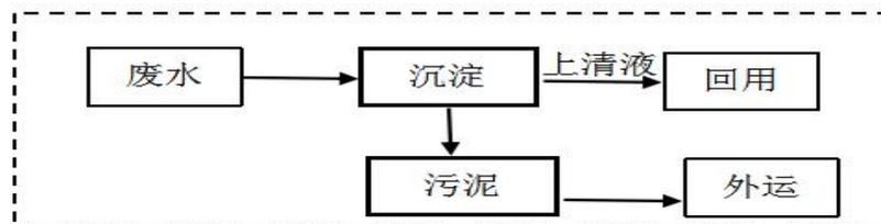
图 4-1 生产废水处理工艺流程图
