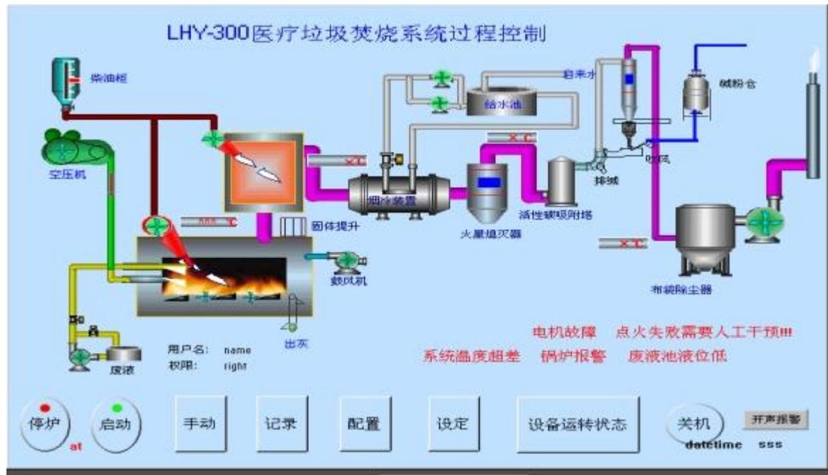
图 3.1.2 医疗废物焚烧工艺流程图（中控系统图）
