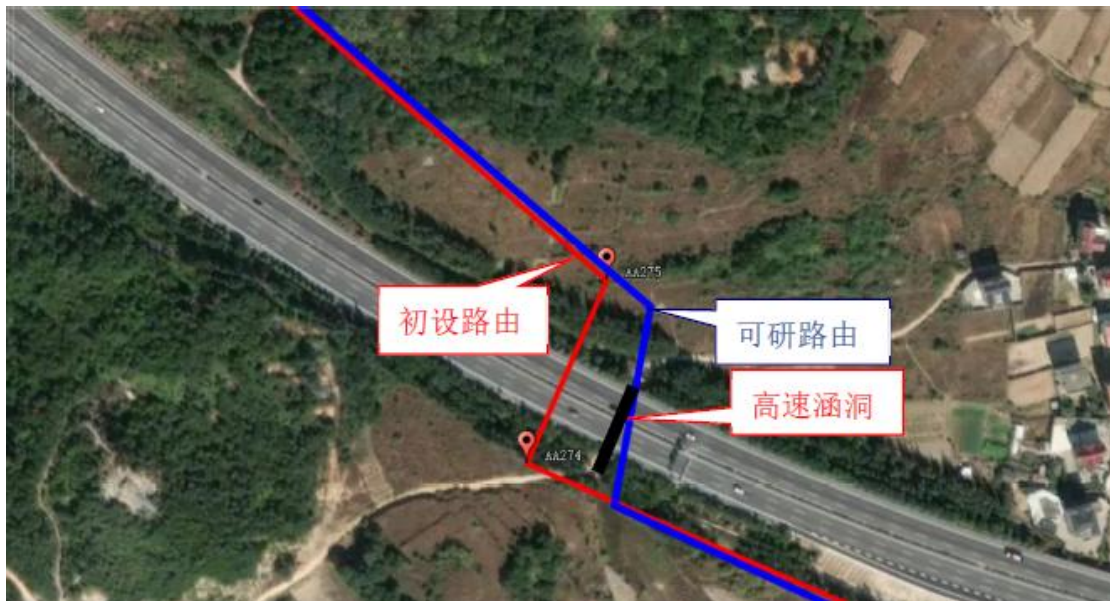
图 3.6-37 可研与初设路由示意图（红线：初设路由；蓝线：可研路由）
