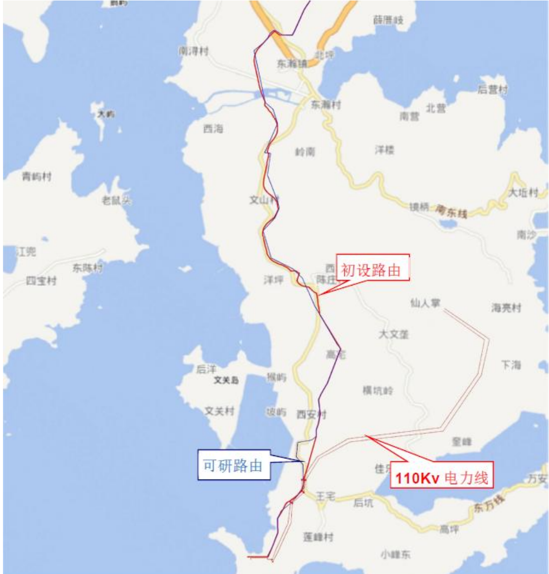
图 3.6-32 可研与初设路由示意图（红线：初设路由；蓝线：可研路由）
