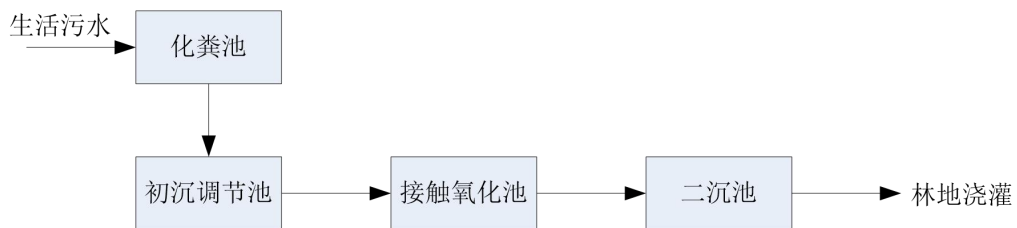
图 4.2-1 生活污水处理设施工艺图
