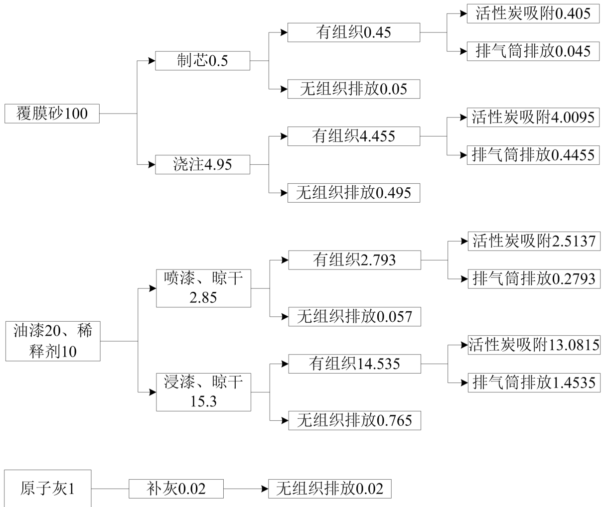
图 3.4-1 挥发性有机物物料平衡图 (单位: t/a)
