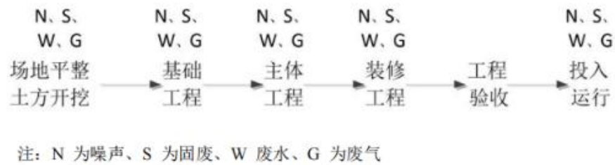
图 2-2 施工期工艺流程及产污环节图
