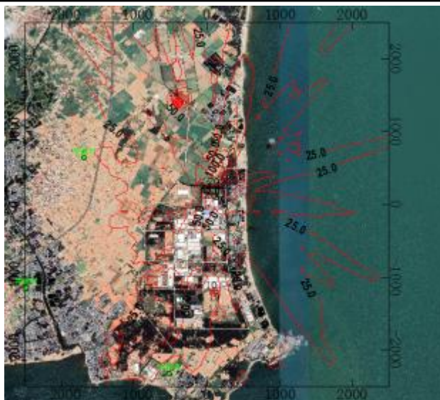
图 5.22 叠加区域拟建源后 NMHC 在敏感点及网格点的小时浓度分布情况
