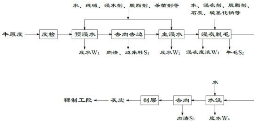
图 2.4 前处理工段工艺流程图
