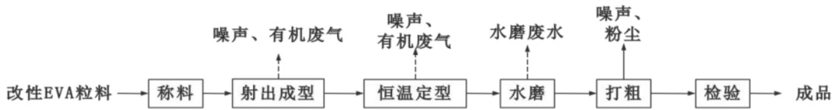
图 3-2 一次 EVA 鞋底生产工艺及产污节点流程图
