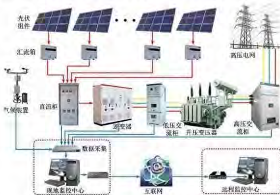
图 2.2-1 光伏并网发电原理图
