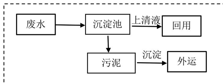
图 4-1 生产废水处理工艺流程图
