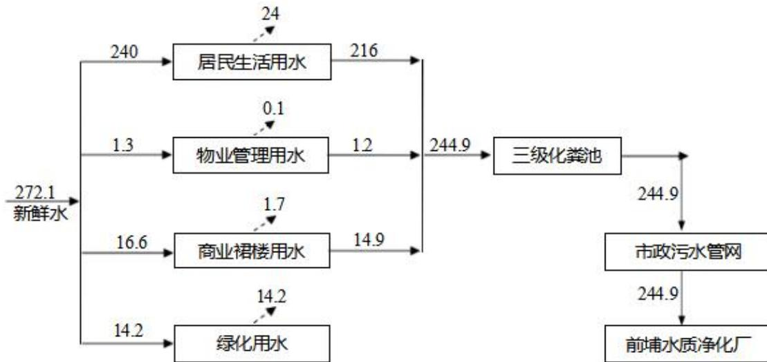
图 3-5 项目用排水水平衡图
