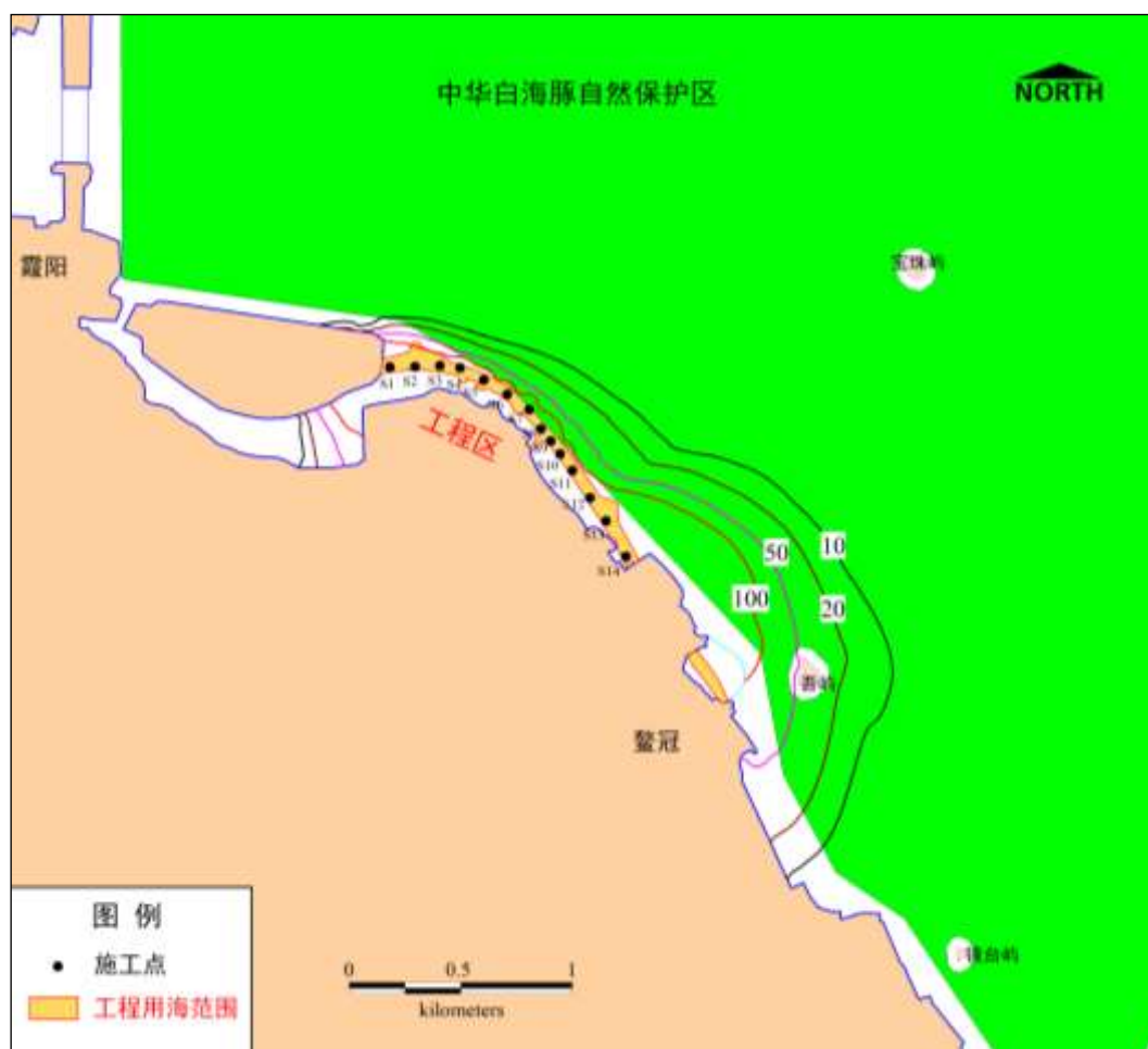
图 5.1-29 项目施工过程中大潮全潮过程悬沙浓度增量最大影响范围图
