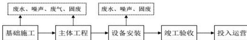
图 4-1：施工期工艺流程及产污节点图
