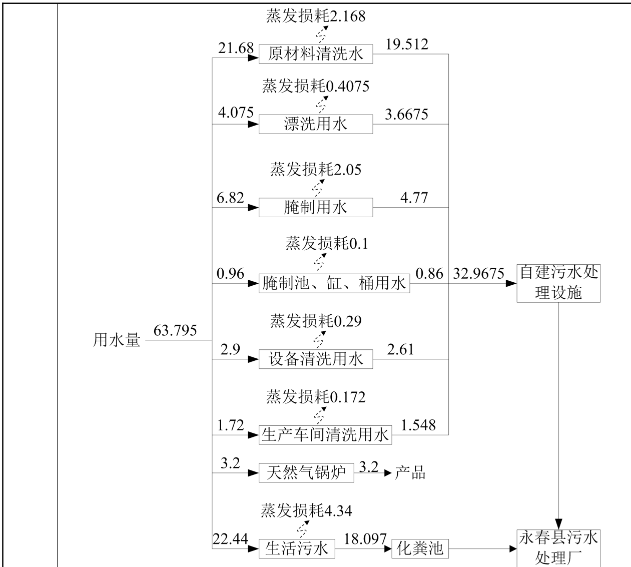
图 2-3 扩建后项目水平衡图 (单位: m³/d)
