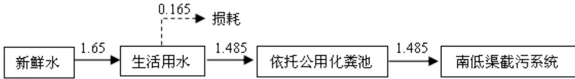
图 3-1 项目水平衡图 单位 t/d
