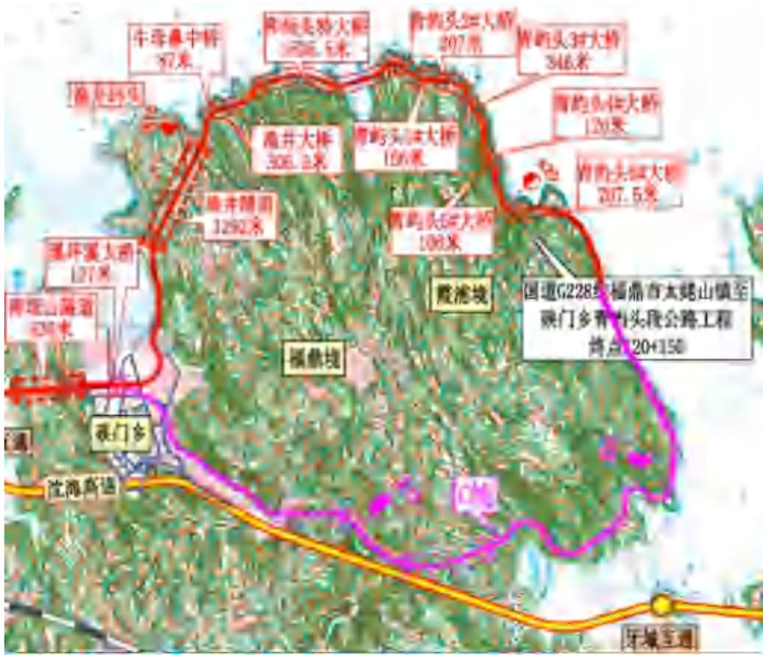
图 3.1-2 南埭山至霞浦界段路线方案平面示意图
