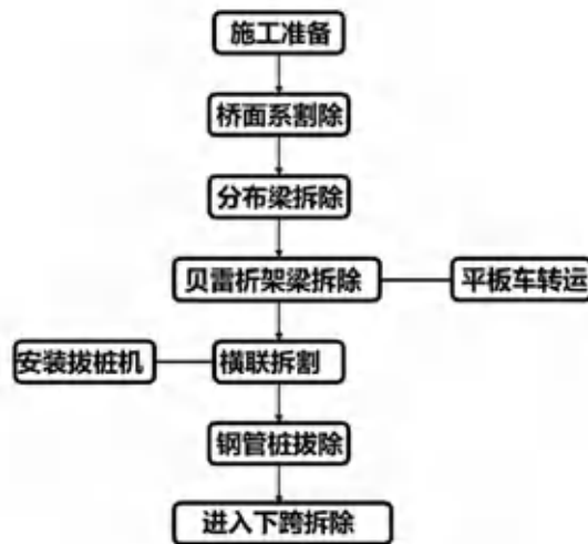
图 3.9-3 施工便桥拆除流程图
