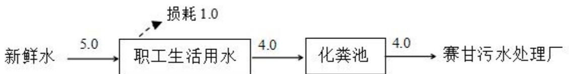
图 3-1 项目水平衡图 (m 3 /d)
