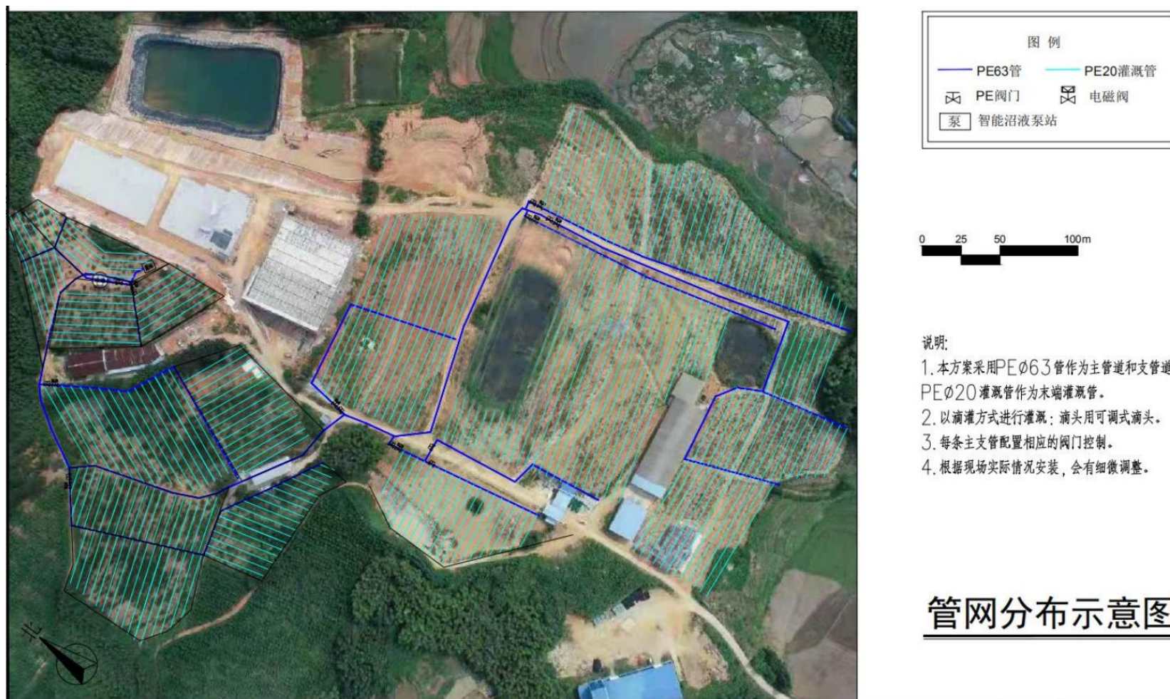
图4.1-5 滴灌系统管道布设示意图
