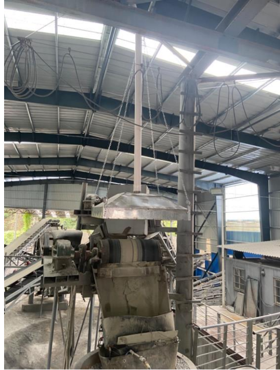
整形工序废气收集集气罩
