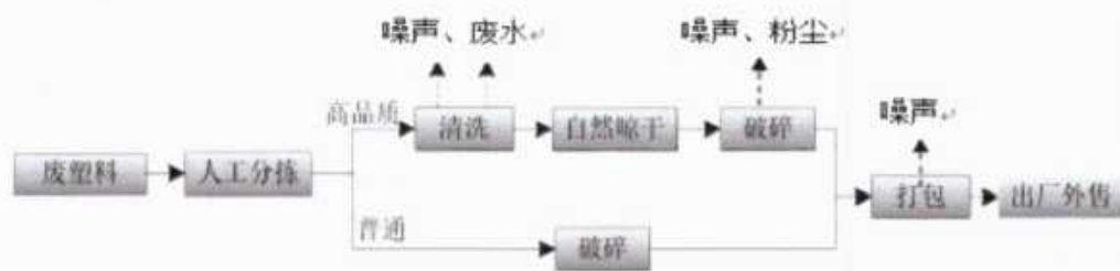
废塑料回收仓储工艺流程图与产污环节图
