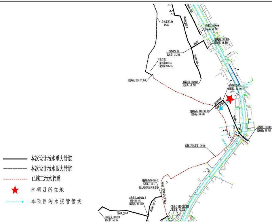
图 4.2-1 云龙乡污水处理厂污水管线图
