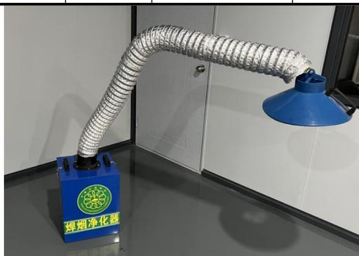
图 4-1 项目焊接烟尘净化器照片
