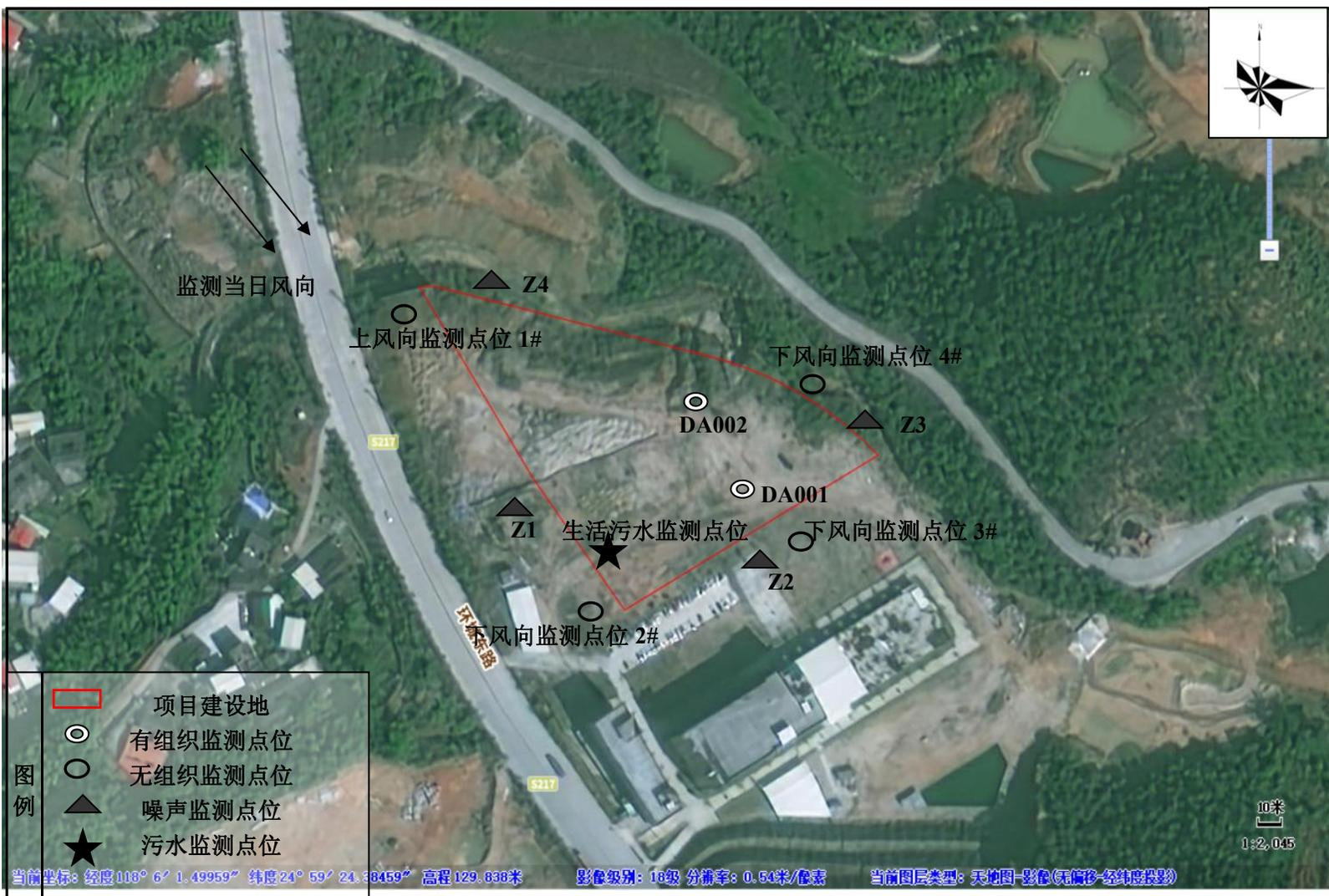
附图5 项目废水、废气、噪声监测点位图
