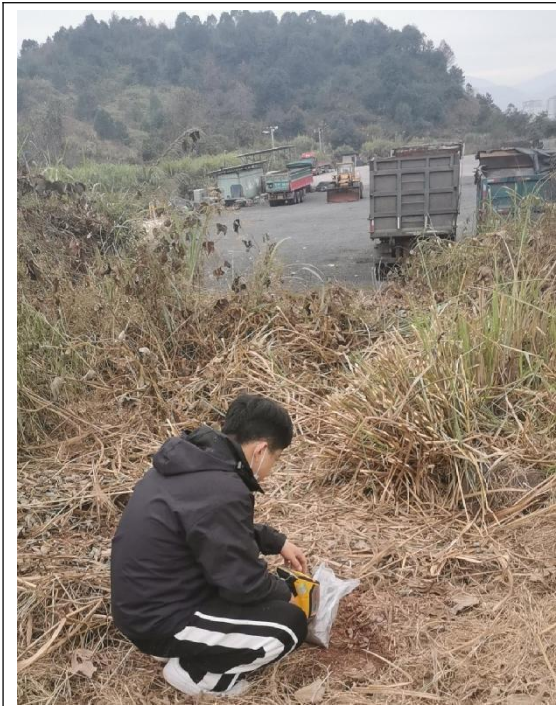
XRF 现场速测照片
