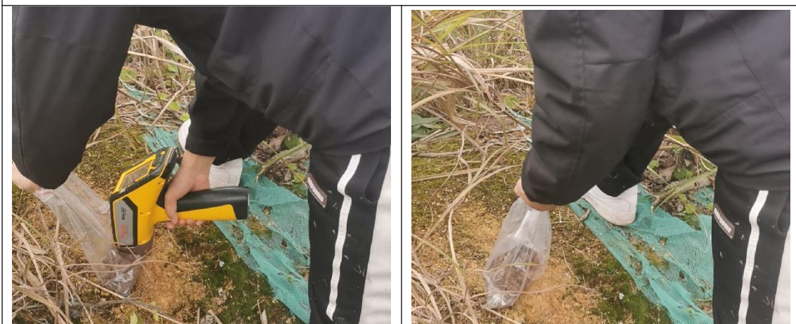
XRF 现场速测照片
