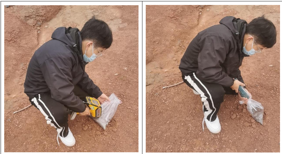
XRF 现场速测照片
