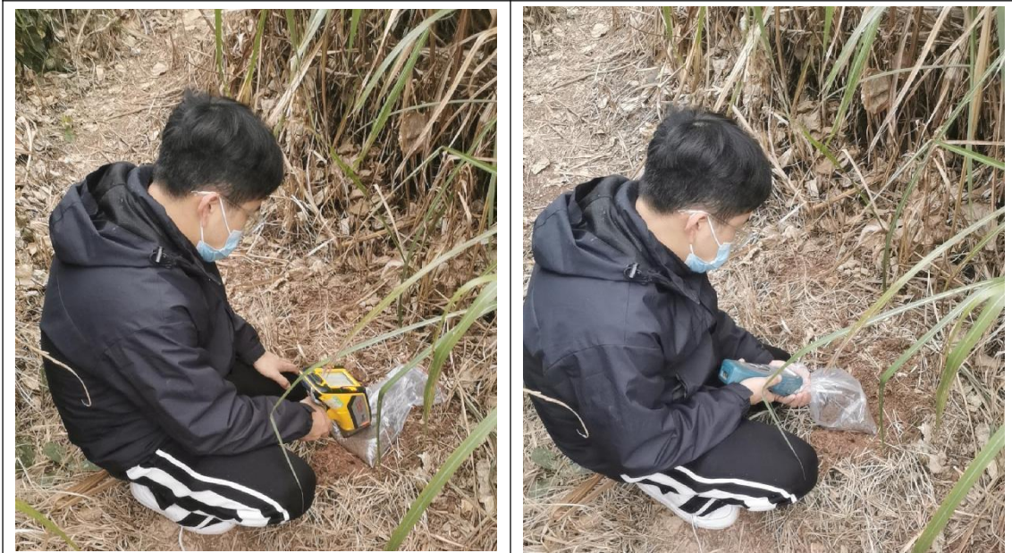
XRF 现场速测照片
