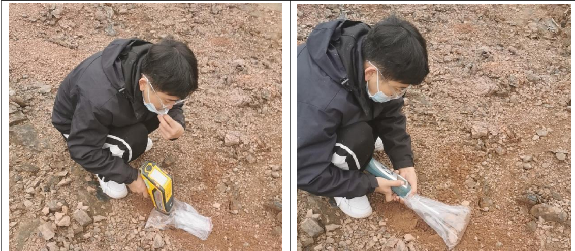
XRF 现场速测照片
