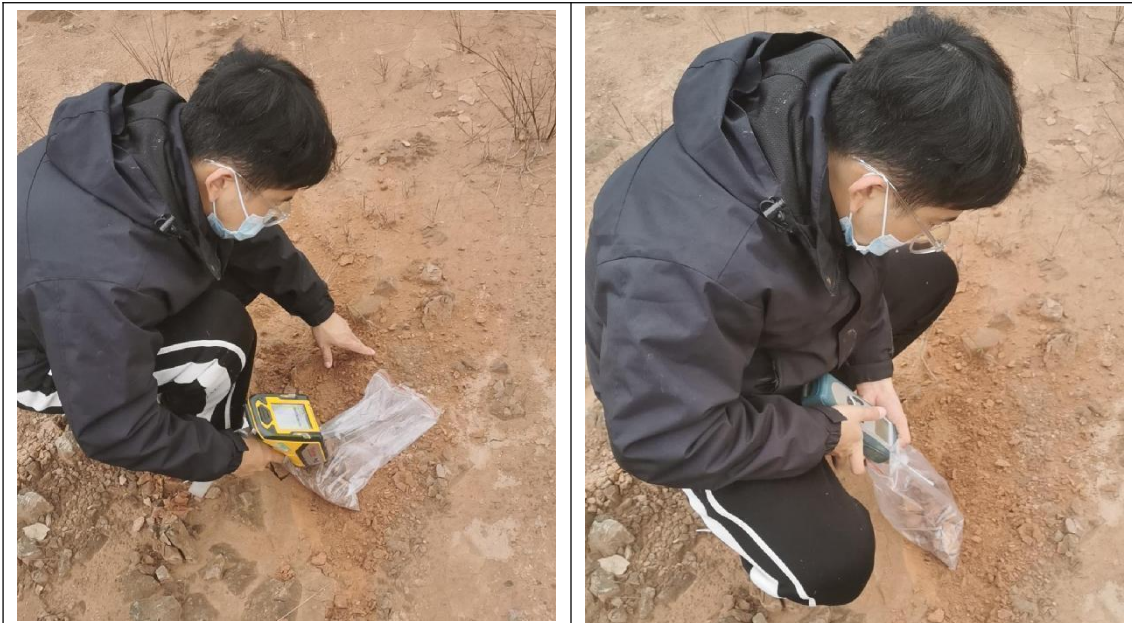
XRF 现场速测照片
