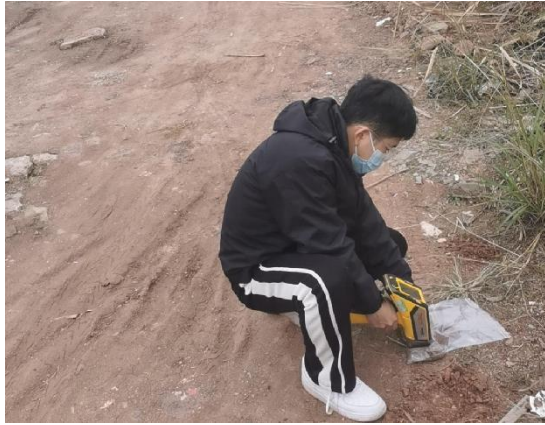
XRF 现场速测照片
