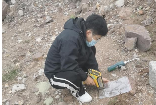
XRF 现场速测照片
