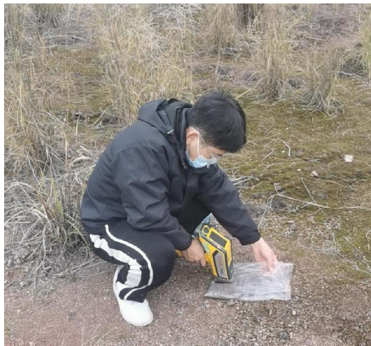
XRF 现场速测照片
