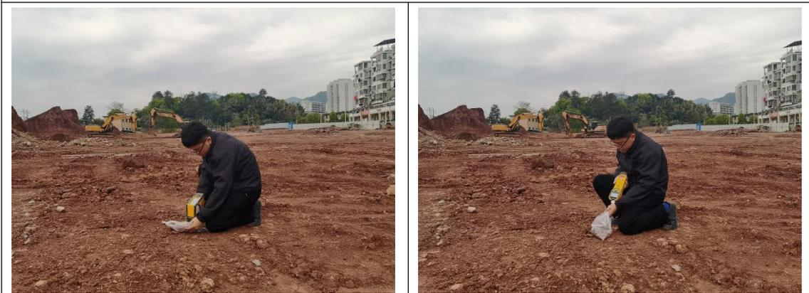
XRF 现场速测照片
