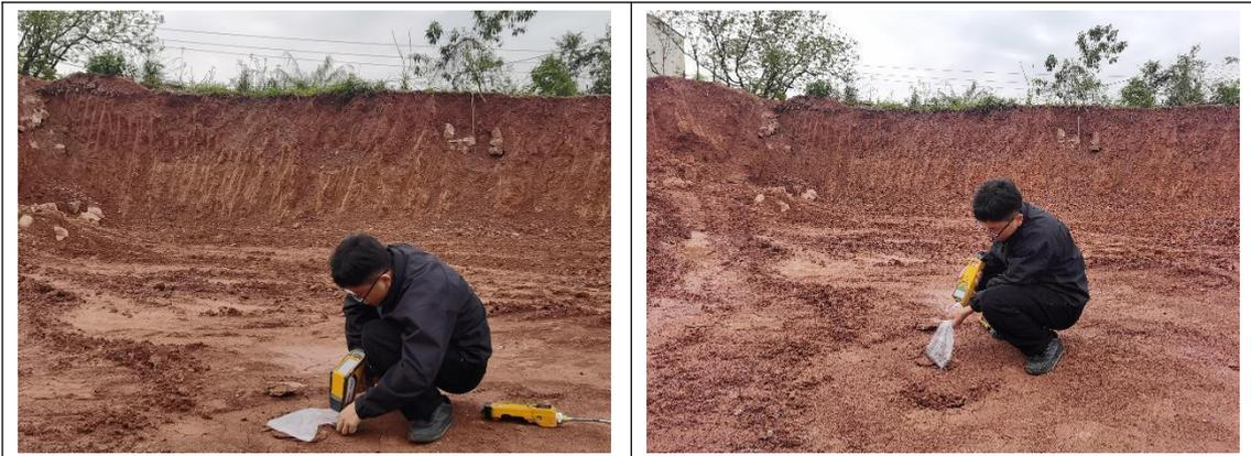
XRF 现场速测照片
