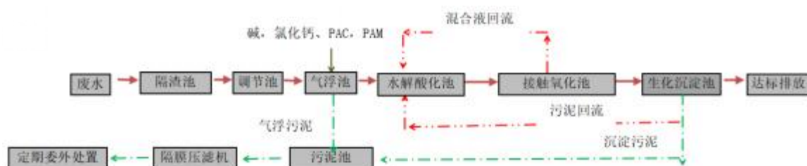
图 4-3 项目生产废水处理工艺流程图
