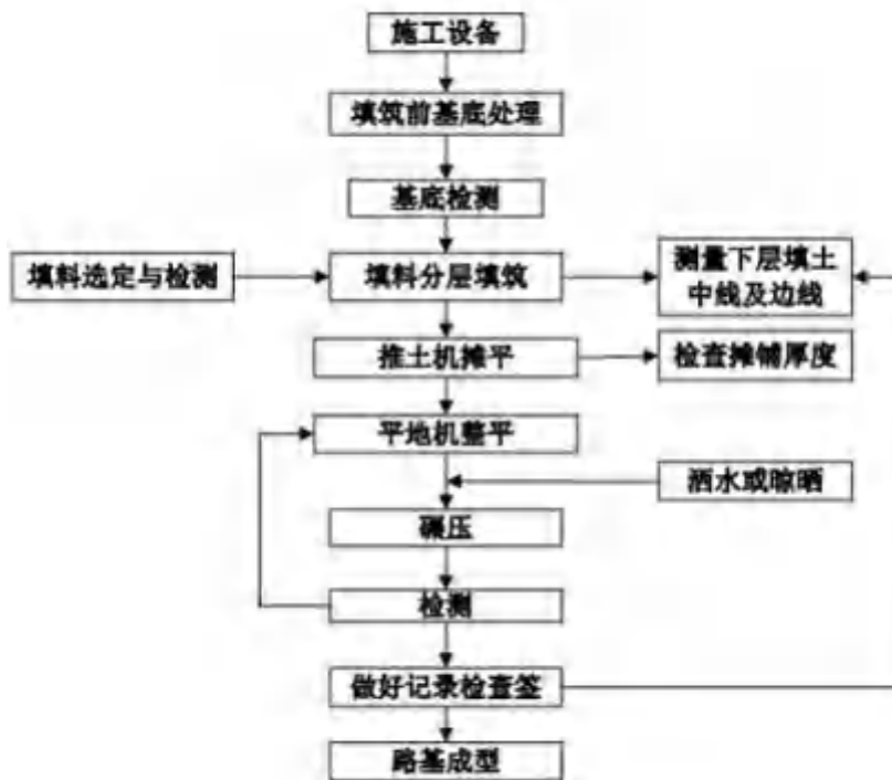
图 3.8-1 填筑路基施工工艺流程
