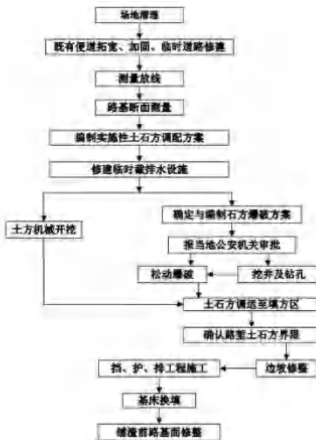
图 3.8-2 挖方路基施工工艺流程
