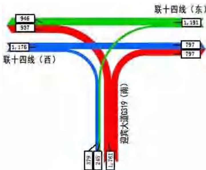
图3.9-1 2043年联十四线—迎宾西路（G319）节点高峰小时交通量分布预测流量流向图（pcu/d）
