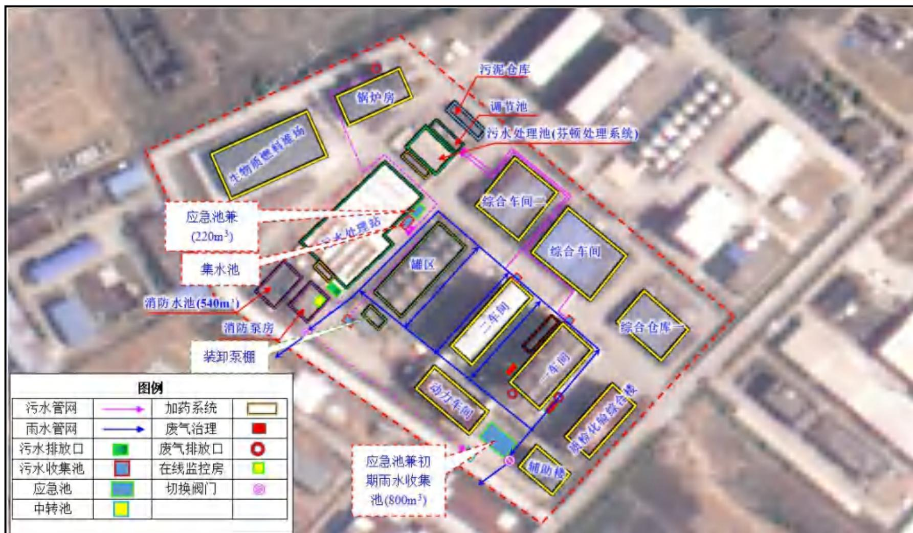
图 4.2-1 总平面布置图（含雨污管网）
