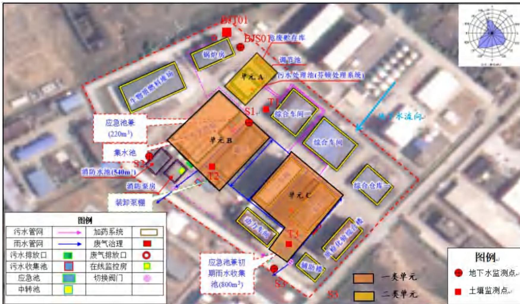
图 6.2-1 厂区地下水及土壤监测点布设示意图
