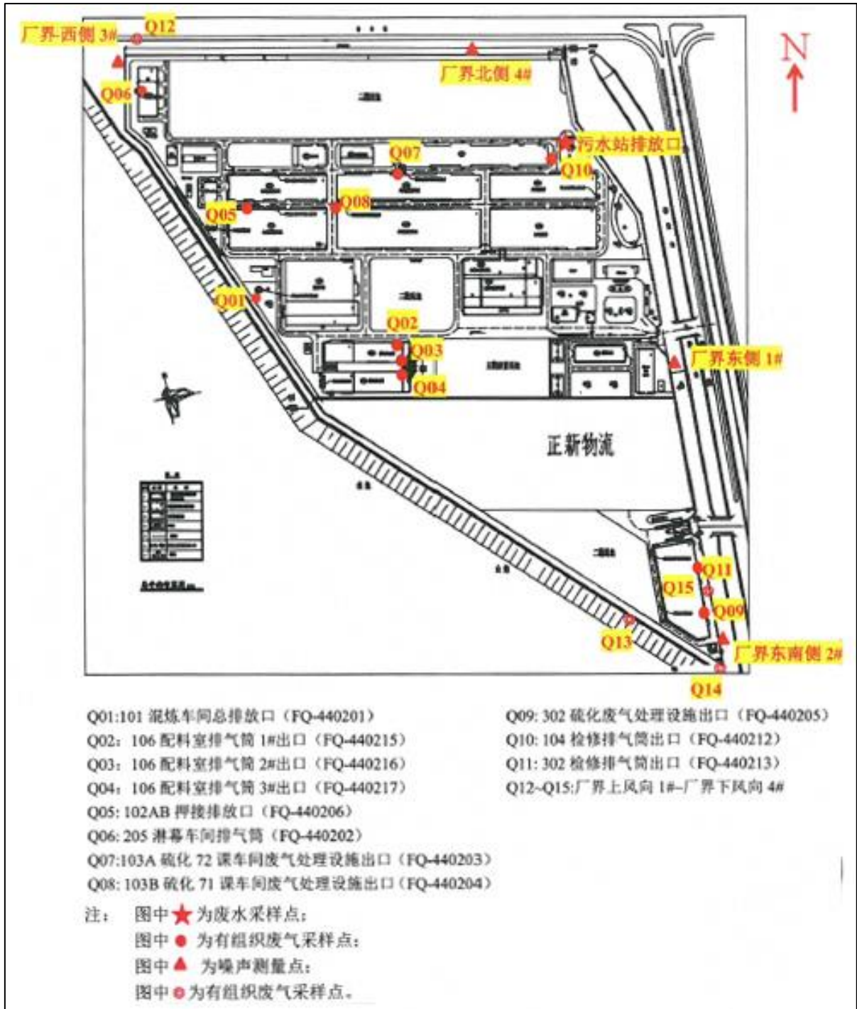
图 2.5-4 有组织废气、噪声、废水排放口监测点位图
