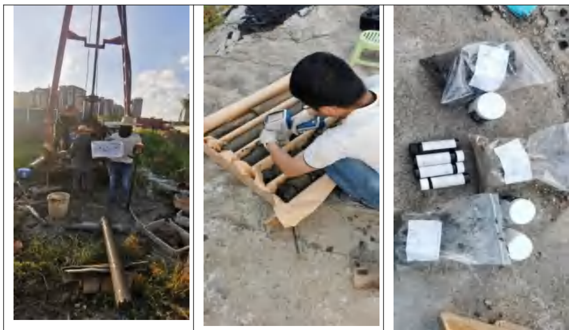
图 5.1-2 土壤样品采集照片（以 T1 点位为例）
