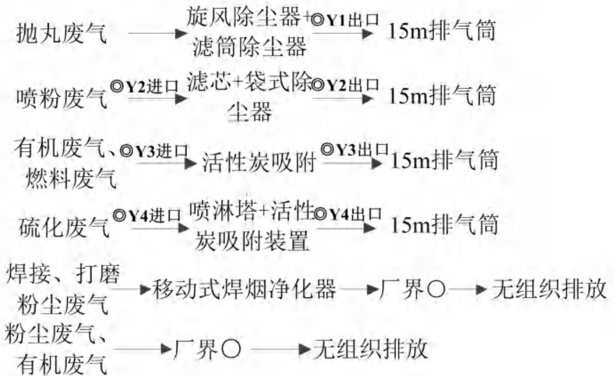
图 3-2 废气处理工艺流程图
