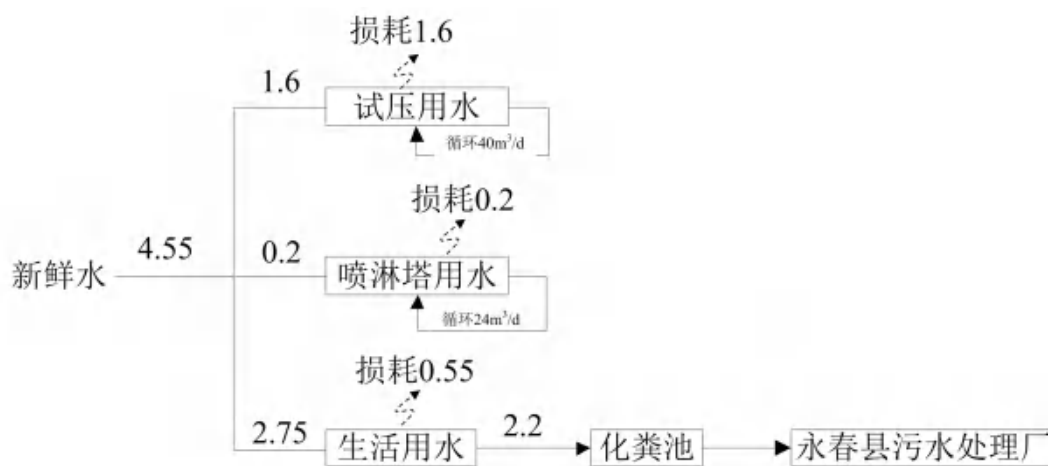
图 2-5 项目水平衡图 单位：t/d
