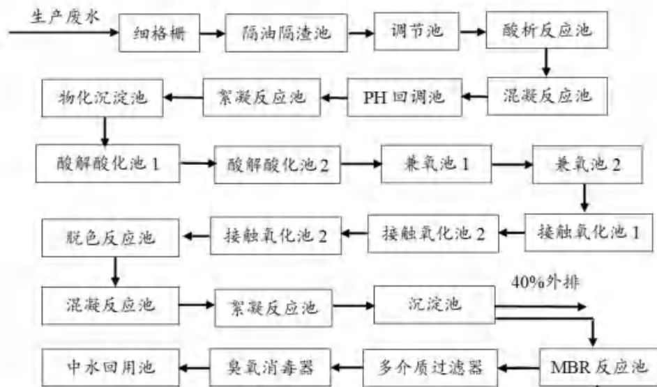
图 4.1.1 生产废水处理工艺流程图
