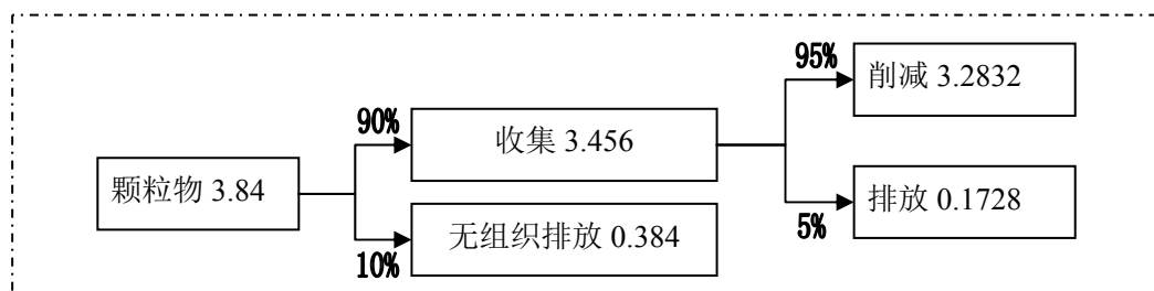
图 4.2-3 扩建部分新增喷粉粉尘物料平衡图（单位：t/a）
