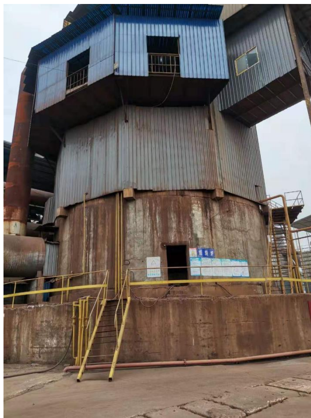
污泥逆流焙烧炉
