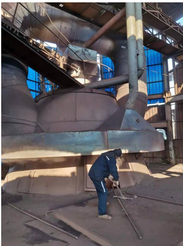
污泥逆流焙烧炉
