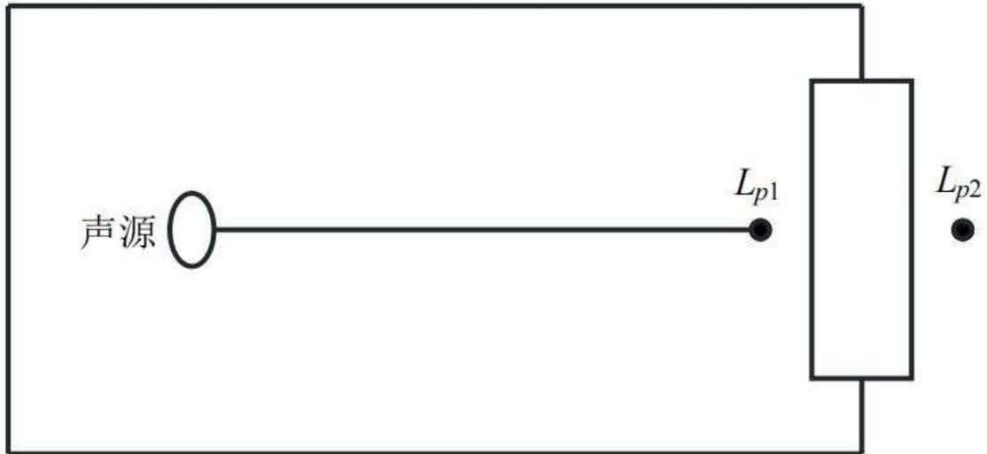
图 5.4-1 室内声源等效为室外声源图例
