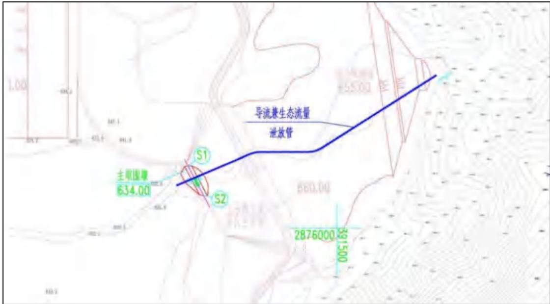
图 2.10-3.环评阶段上水库生态泄放管平面布置图
