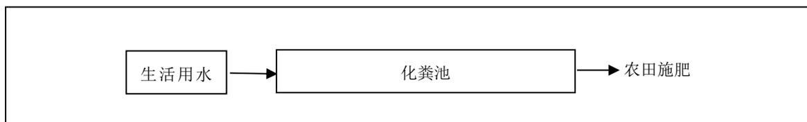
图 4-1 废水处理工艺流程图
