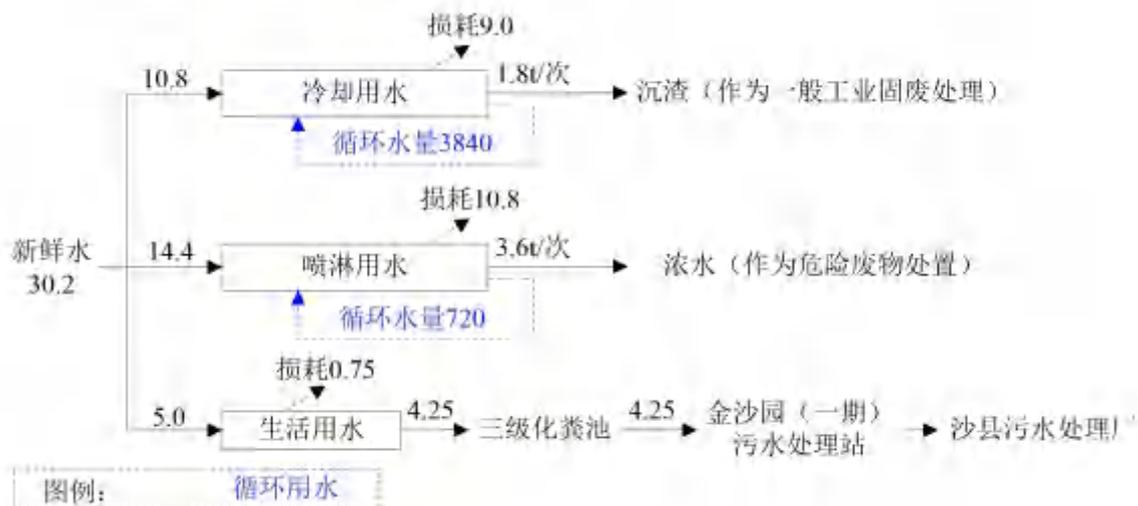
图 3-16 项目用排水平衡图（最大日） 单位：t/d
