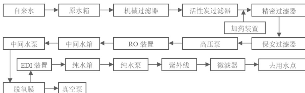
图 2.2-2 纯水制备工艺流程示意图
