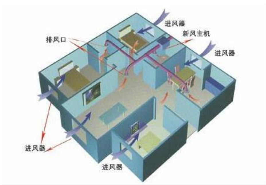
图 2.8-3 新风系统原理示意图
