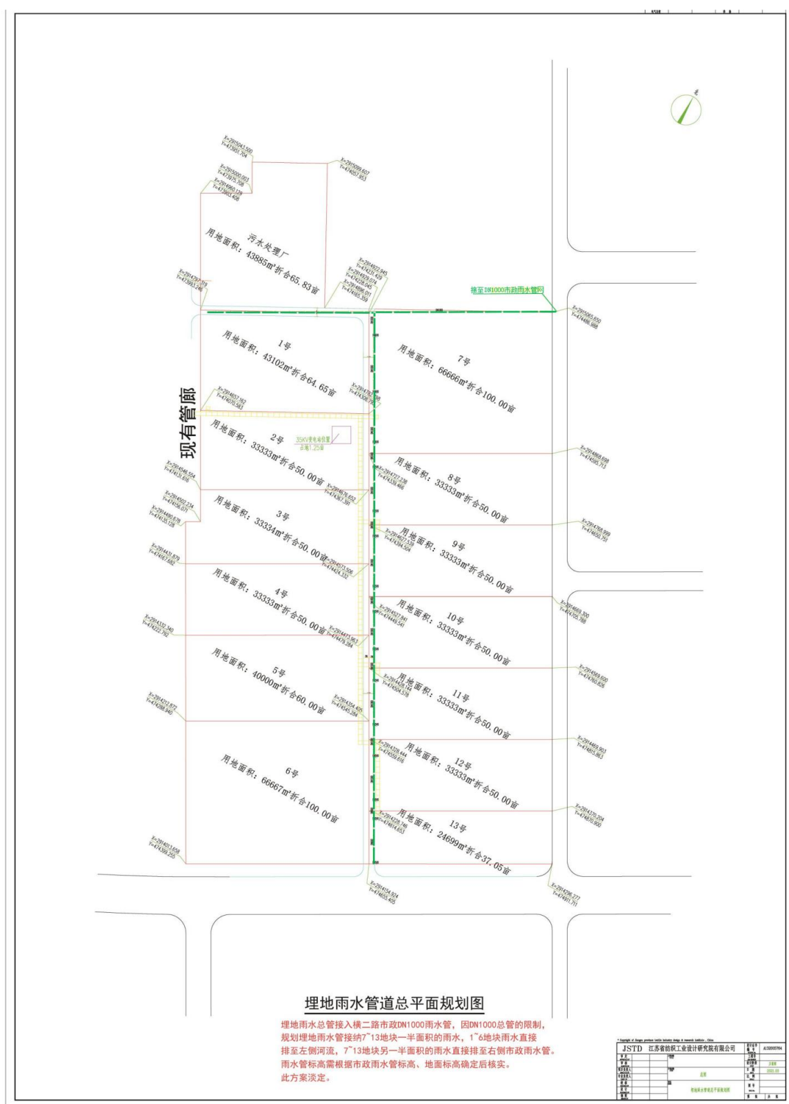
图 4.3-4 可门绿色纺织产业园埋地雨水管道总平面规划图
