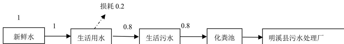
图 3.4-1 项目水平衡图 (单位: t/d)
