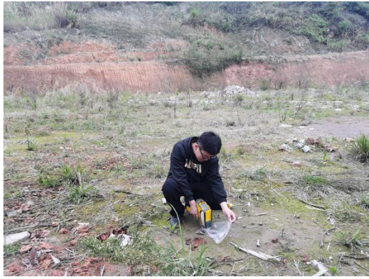
XRF 现场速测照片
