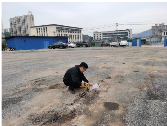
XRF 现场速测照片
