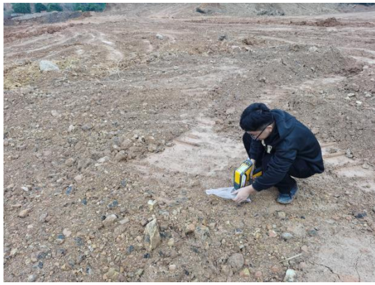
XRF 现场速测照片
