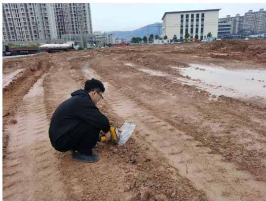
XRF 现场速测照片
