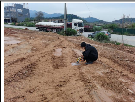
XRF 现场速测照片
