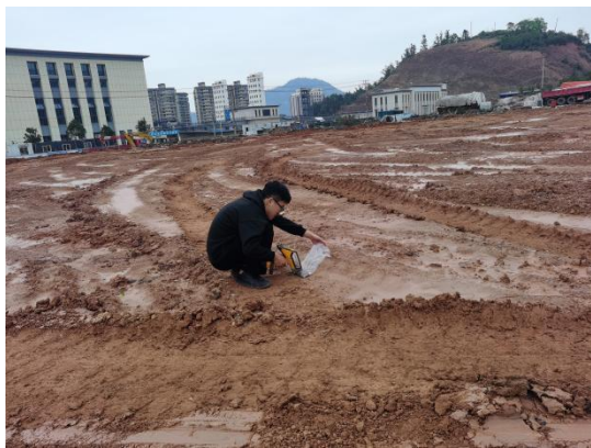
XRF 现场速测照片
