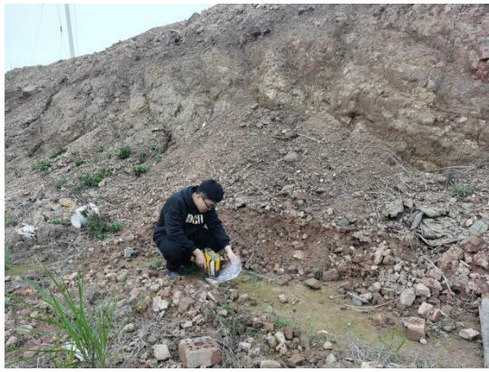
XRF 现场速测照片
