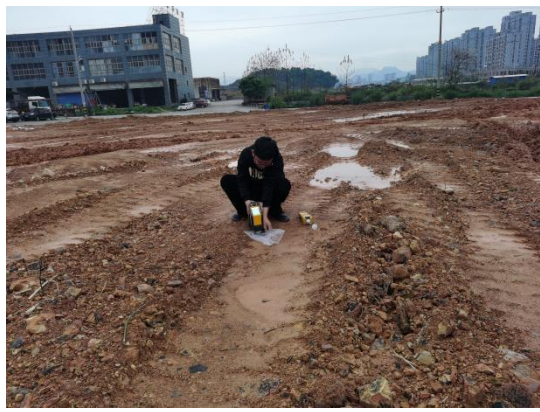
XRF 现场速测照片
