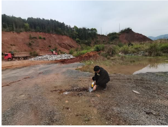
XRF 现场速测照片
