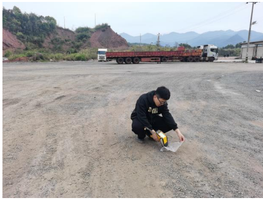
XRF 现场速测照片
