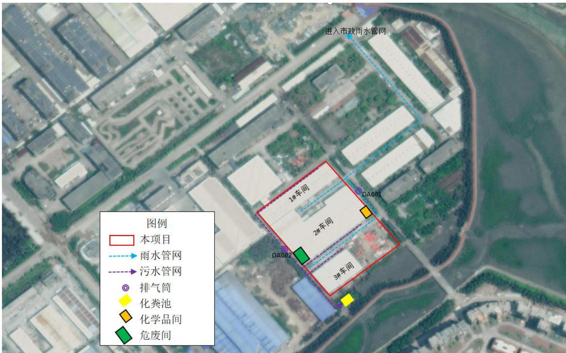
图 3-3 项目总平面布置及雨污管网图
