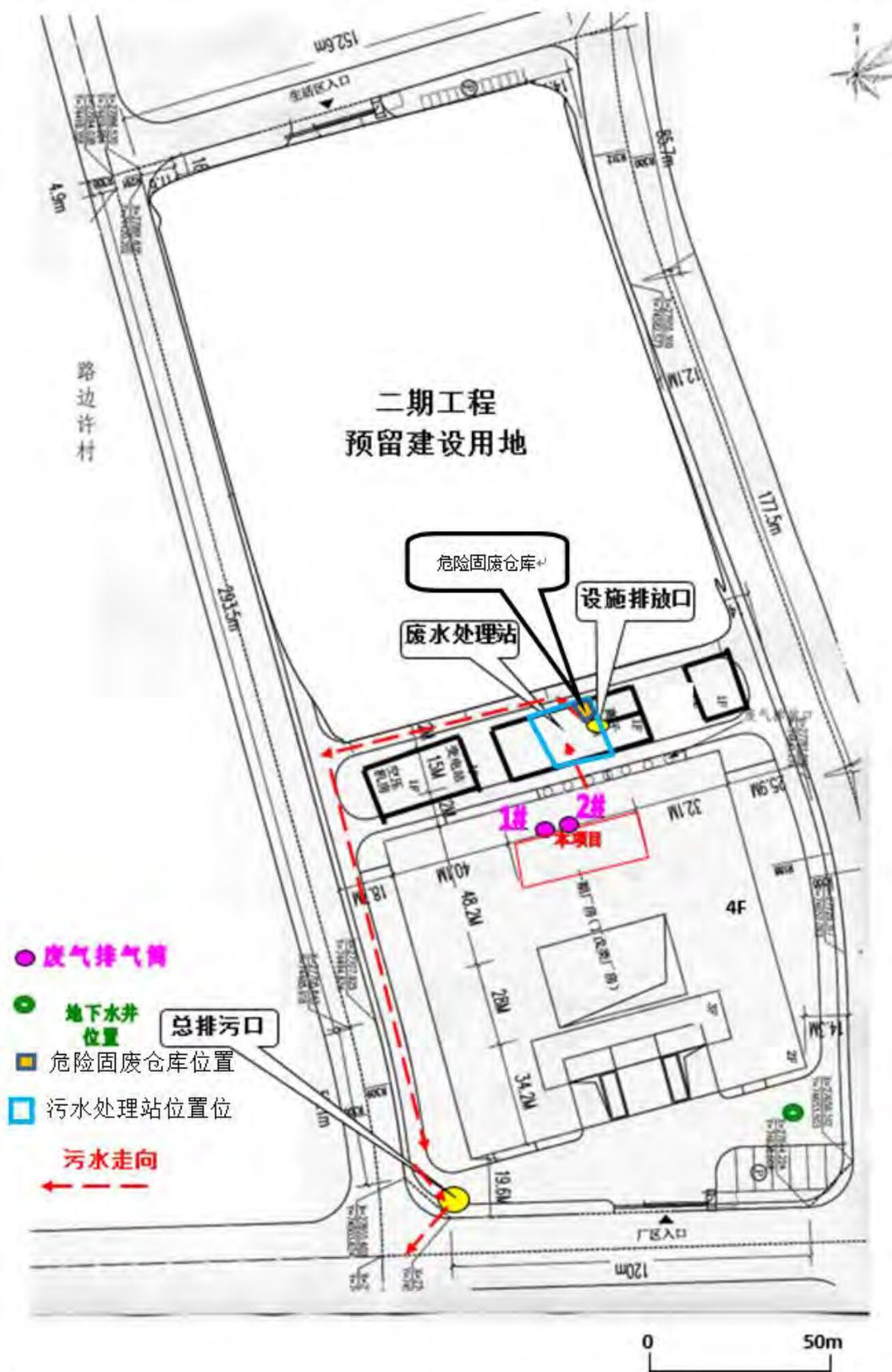
图 3.1.3 厂区平面布置及污水管网图
