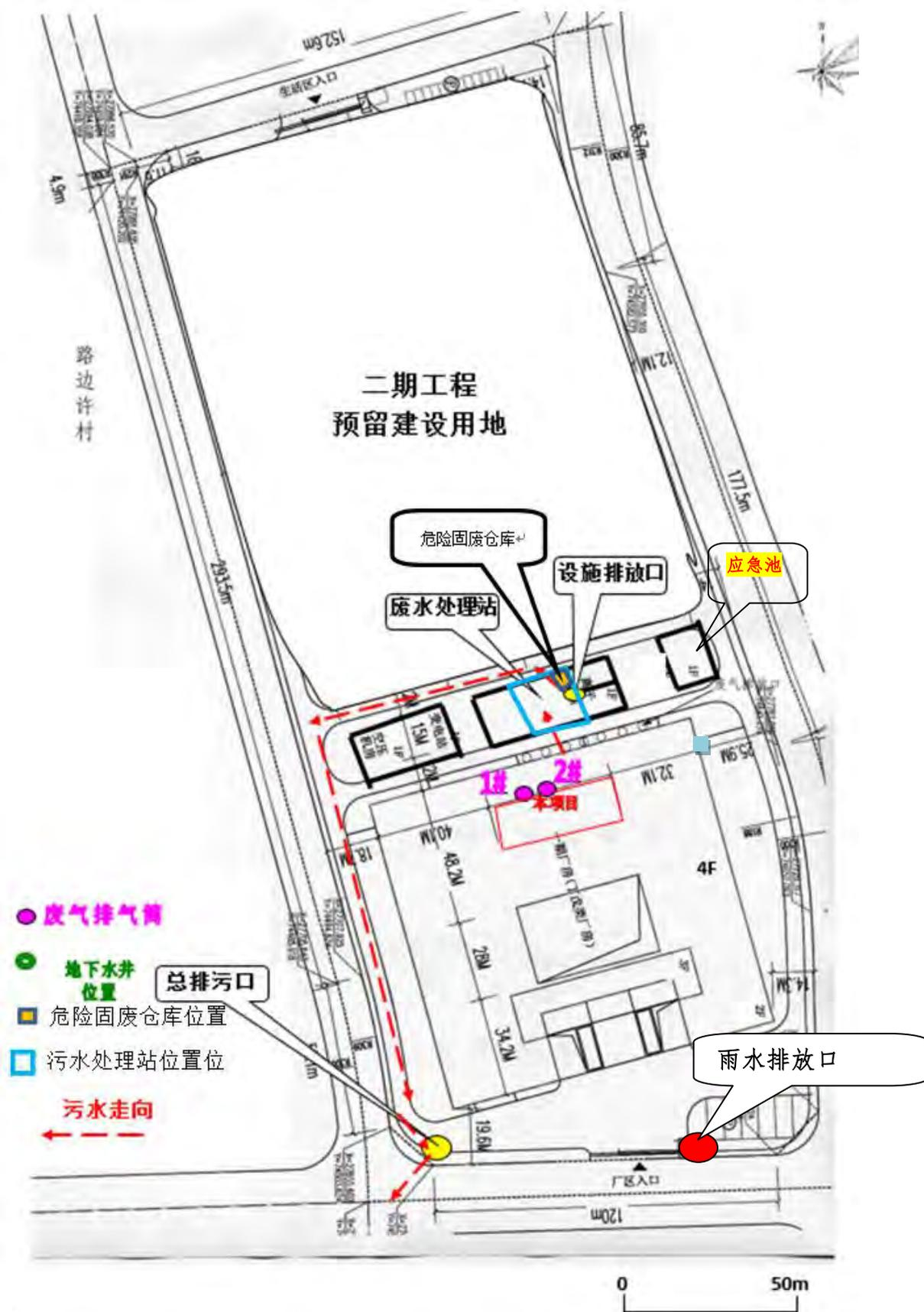
图 10.4.1 厂区平面布置及污水管网图
